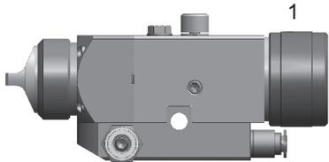
Drehen Sie die Kappe (1) aus der Grundeinstellung (= Kerbe am Kolbengehäuse).
