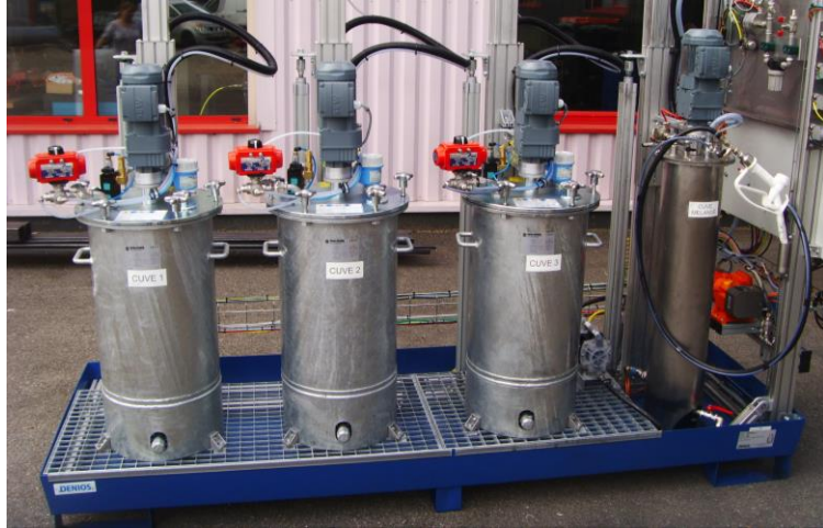
Unité de préparation lubrifiant
