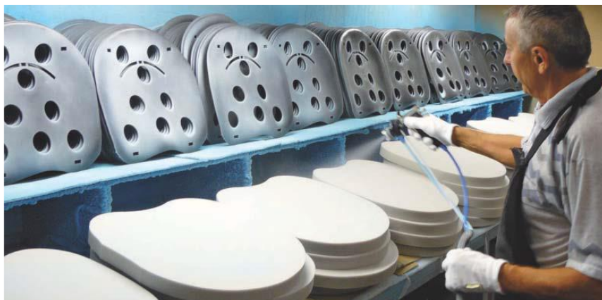
Colle aqueuse contacte bi-composante pour assemblage de sièges
