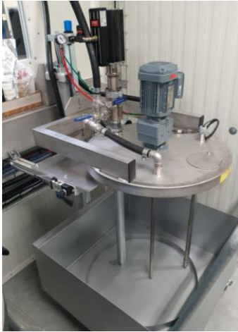
Élevateur simple avec agitateur électrique
