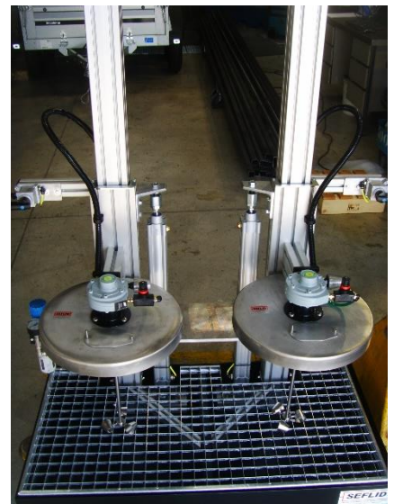
Élevateur double avec agitateur pneumatique
