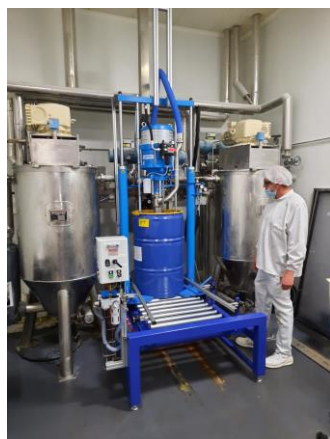
Unité d'extrusion avec ensemble double RAM
