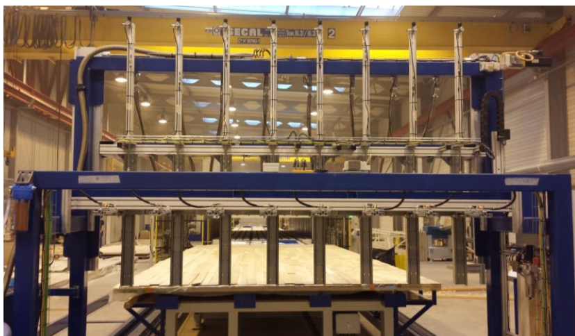
Rampe verticale de pulvérisation pour encollage de panneaux de bois
