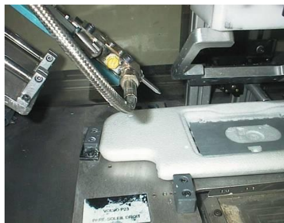
Extrusion de colle sur un pare-soleil de voiture
