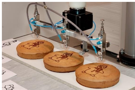
Dépose fine et régulière selon modèle DAO
