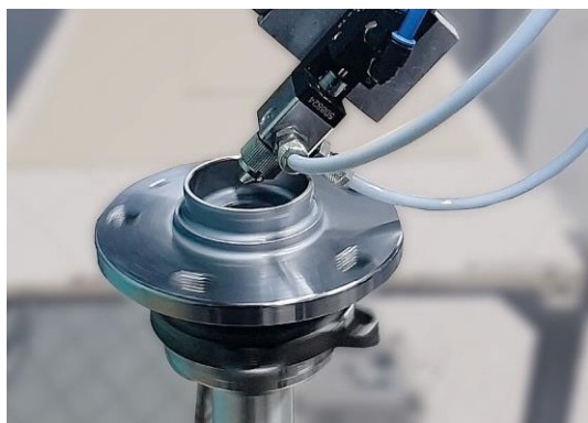
Dépose d'une peinture avec pigments de zinc
