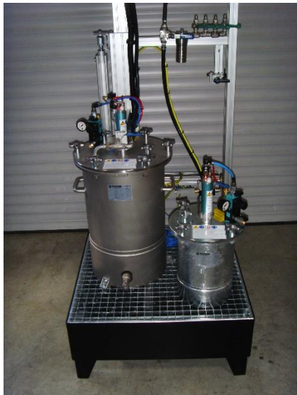
Élevateur simple pour cuve sous pression
