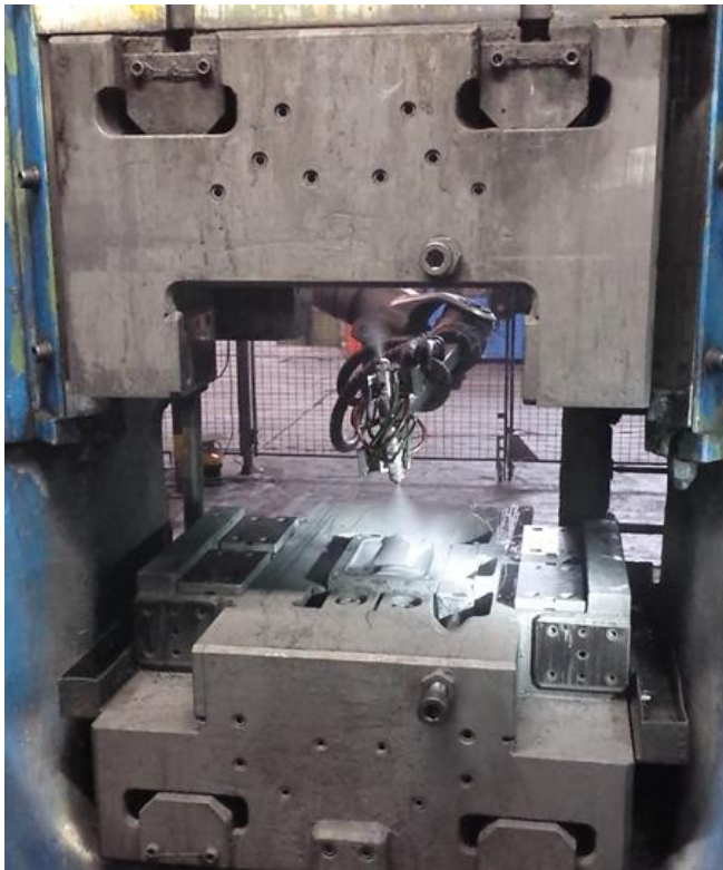
Poste robotisé de lubrification de moules
