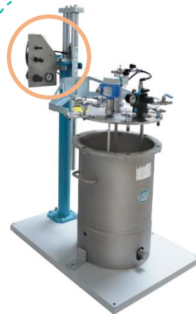
Monte et baisse contrôle agitateur
