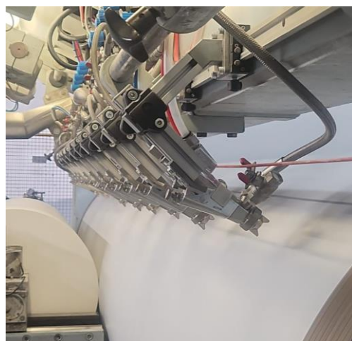
Rampe de pulvérisation de colle naturelle sur des rouleaux de papier
