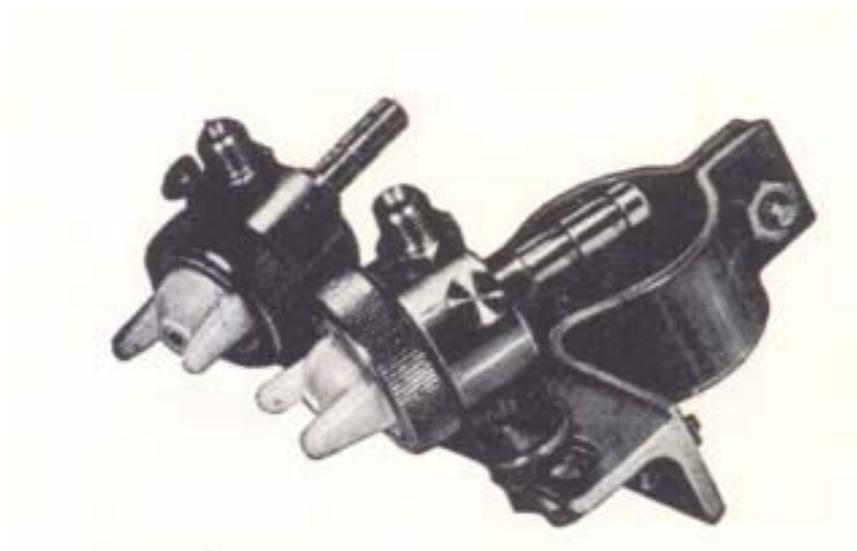
Pour installations automatiques des miroiteries. Avec 2 têtes à air jet rond-plat-large en matériaux synthétiques. Toutes les pièces en contact avec le produit sont en inox. Les 2 corps sont montés sur un support angulaire. L'angle du jet, formé par les axes longitudinaux, est réglable.
